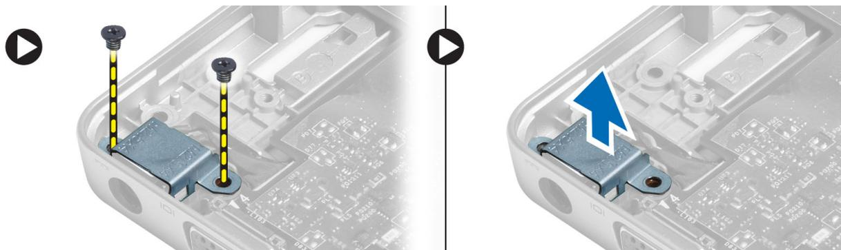
6. Remova os parafusos que prendem a placa de sistema ao computador e remova-a.
